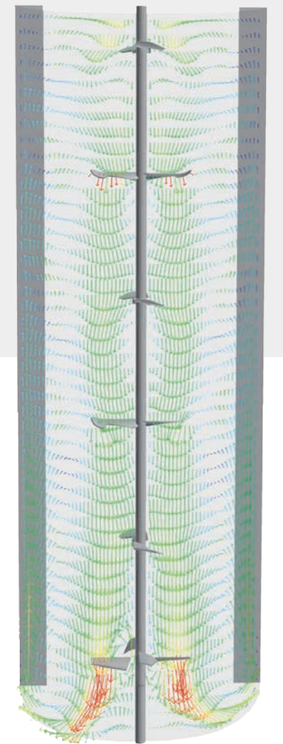
Короткое время перемешивания благодаря конструкции ЕКАТО осевого циркулятора вертикального типа
